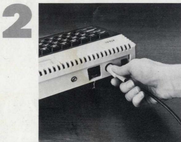
**2** Branchez la prise ronde de l'adaptateur de courant à la prise "POWER IN" située à l'arrière de l'ordinateur. Branchez la prise de l'adaptateur de courant à la prise de courant.
